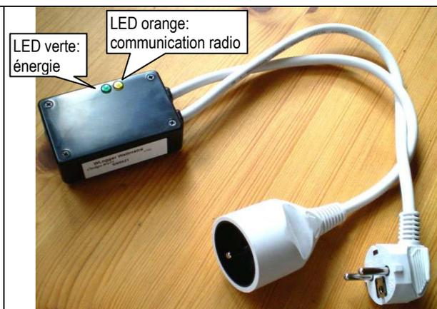
La LED verte clignote proportionnellement à la puissance mesurée : 1Hz = 60 Watts
